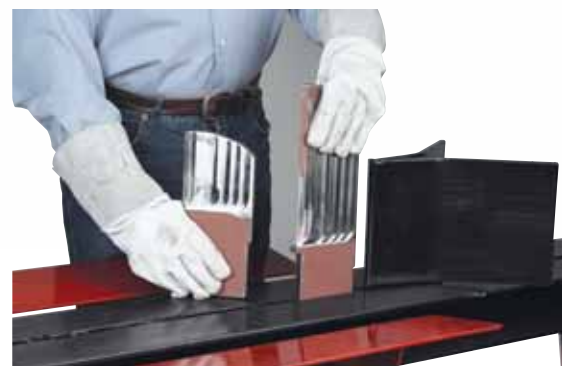
Je nach Holzstärke und Qualität können unterschiedliche Messer eingesetzt werden
