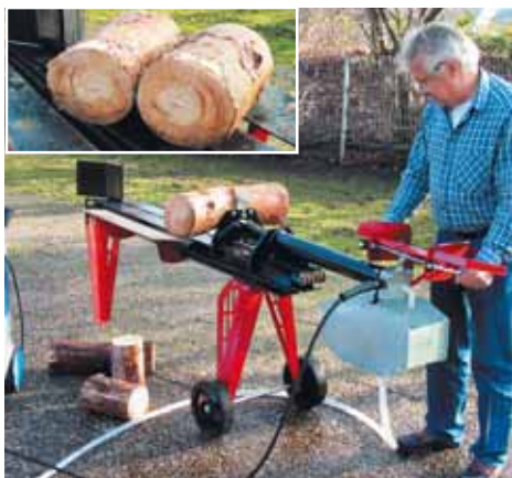
Mit 150 bar Wasserdruck haben wir 16, mit 200 bar sogar über 20 Zentimeter dicke Hölzer quer geschnitten. Die Schnittflächen sind so sauber wie gesägt
