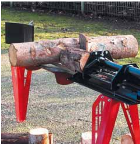
Da der Schneidstahl gesteckt ist, kann er mit dem feststehenden Holz einfach umgedreht und so gelöst werden
